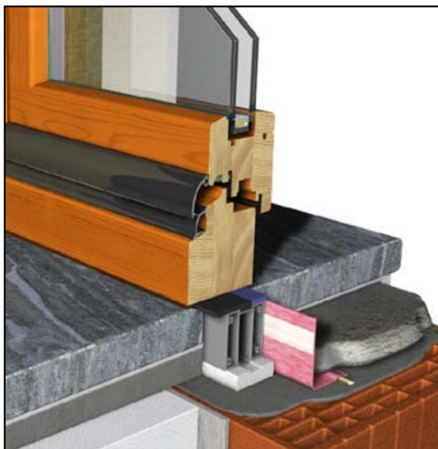
Ma cosa troviamo se si analizza l'intero sistema finestra, comprensivo del nodo di collegamento tra telaio e controtelaio (nodo secondario) e tra controtelaio e muro (nodo primario)?
